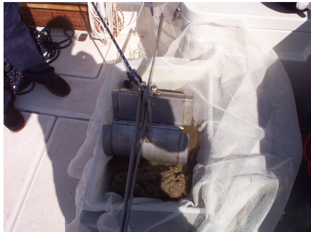
Toma de muestras mediante draga Van Veen
